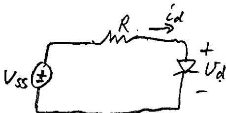
$$KVL: 0 = -V_{ss} + R \cdot i_d + V_d$$
